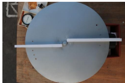
Рис. 2. Загальний вигляд установки для визначення дальності польоту частинки
