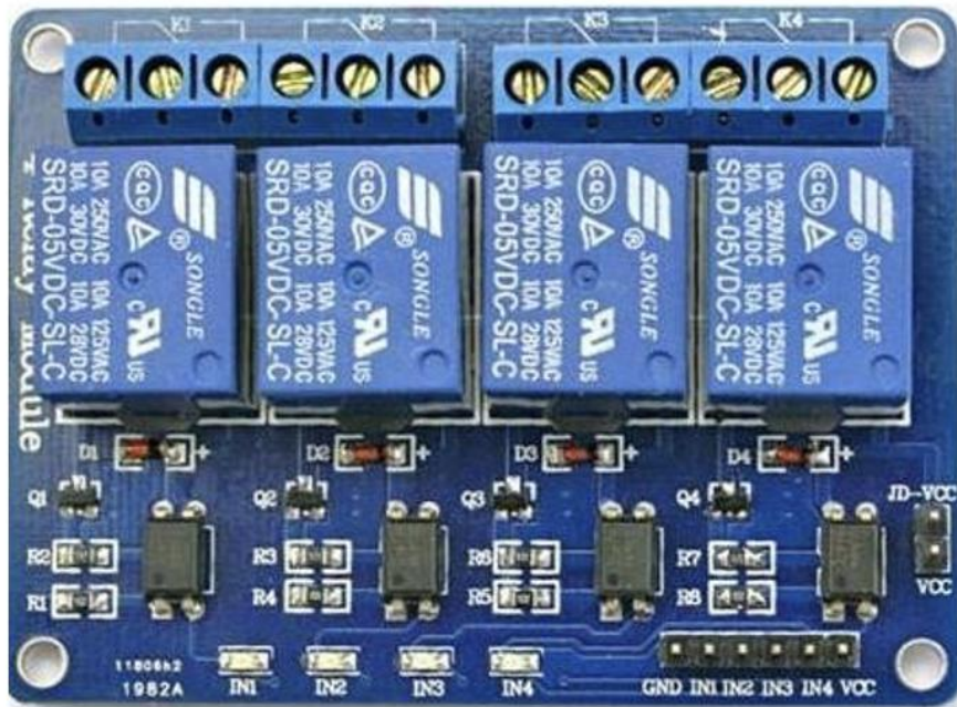
Рисунок 2.6 «Реле 4-х каналъне»
