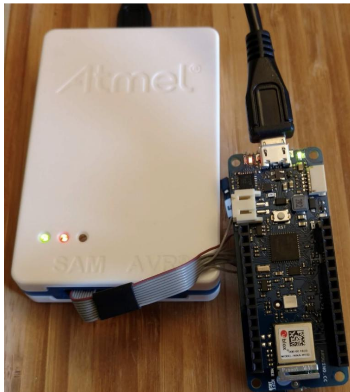
Рисунок 4.2 Підключення відлагоджувача Atmel-ICE до плати MKR WiFi 1010 через SWD-інтерфейс
