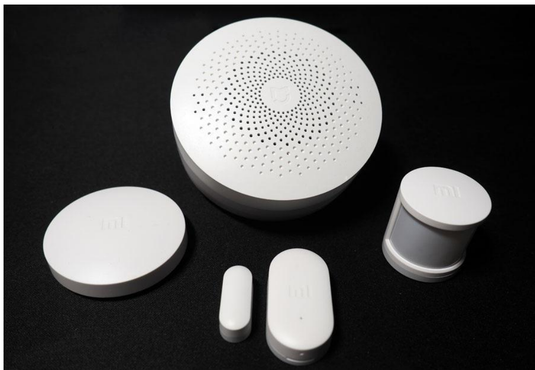
Рисунок 2.2 – Система «розумного будинку» Хіаомі Міжіа
