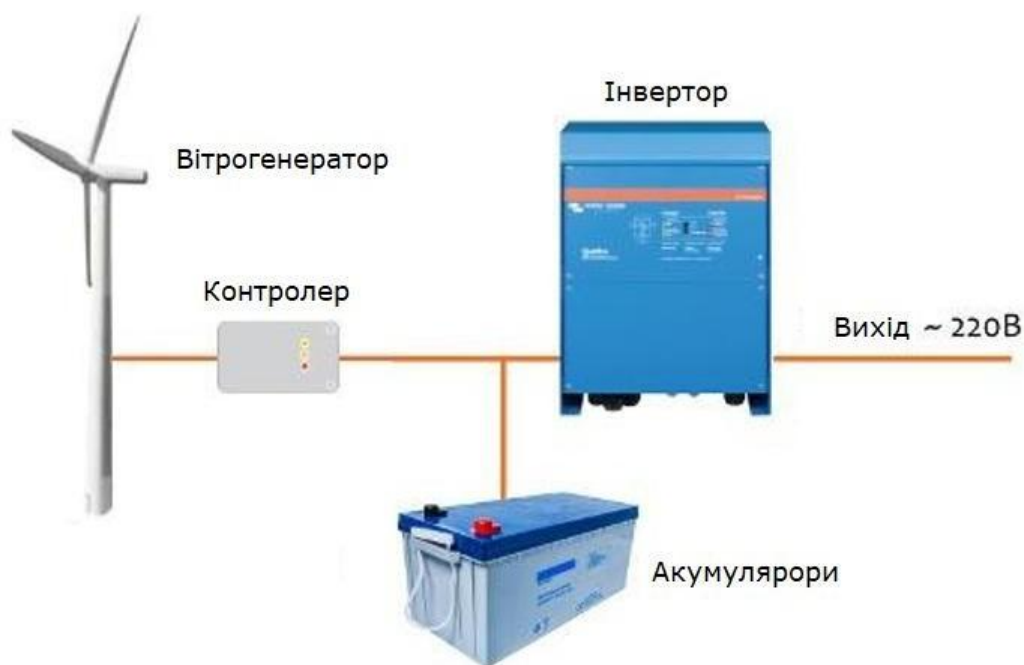
Рисунок 2.12 – Система автономного електропостачання «розумного будинку»
