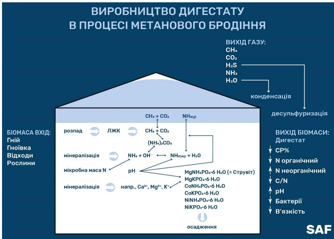
Рис. 2.21. Виробництво дигестату в процесі метанового бродіння [72, 214]
