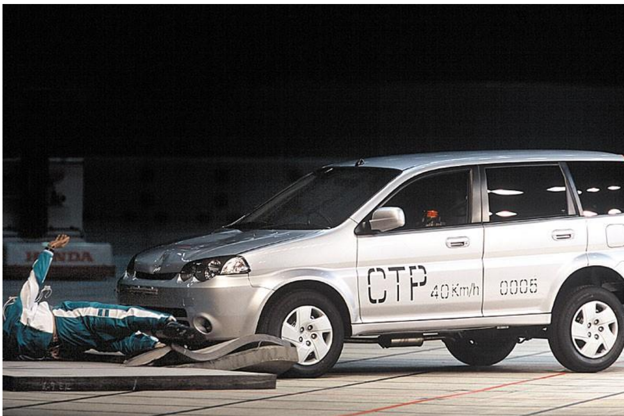
Рисунок 1.2 – Кінематика наїзду автомобіля на пішохода
