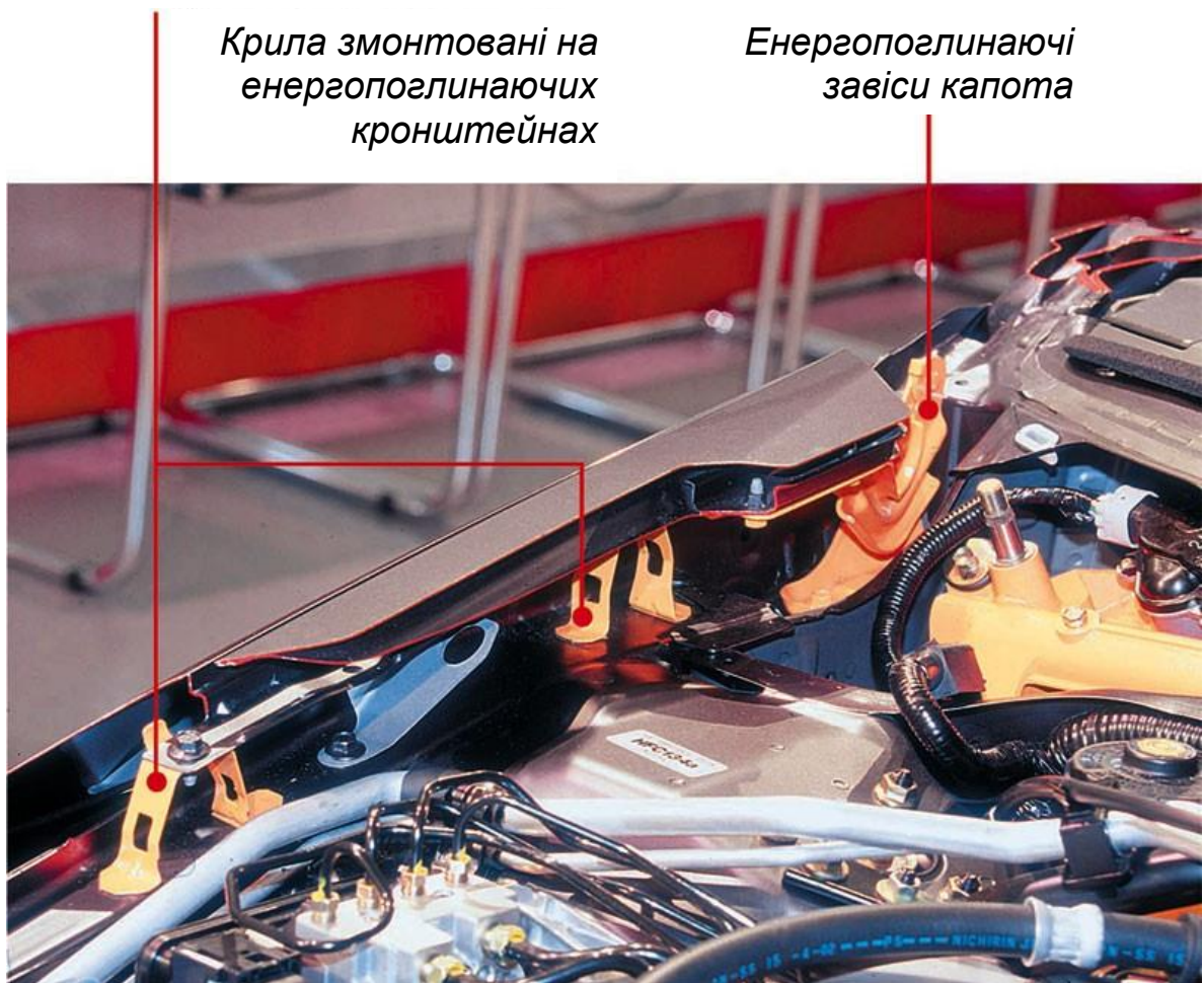
Рисунок 1.7 – Енергопоглинаючі елементи капота автомобіля
