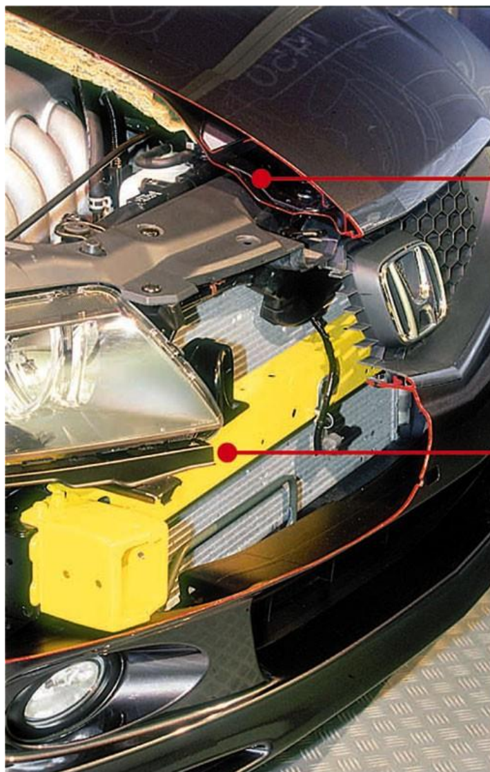
Рисунок 1.6 – Травмобезпечна передня частина автомобіля
