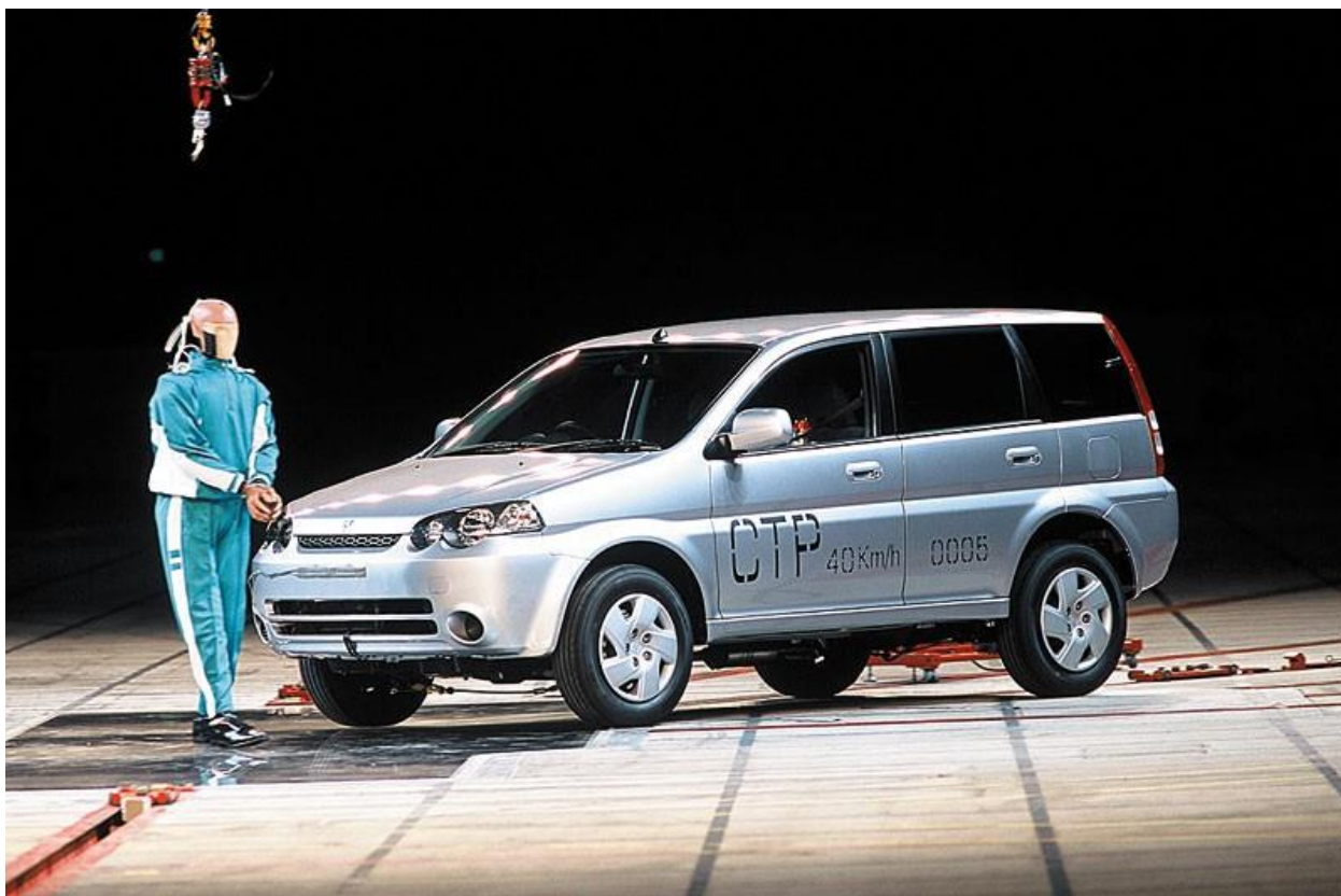
Рисунок 1.1 – Моделювання кінематики руху тіла під час наїзду автомобіля з однооб'ємним кузовом
