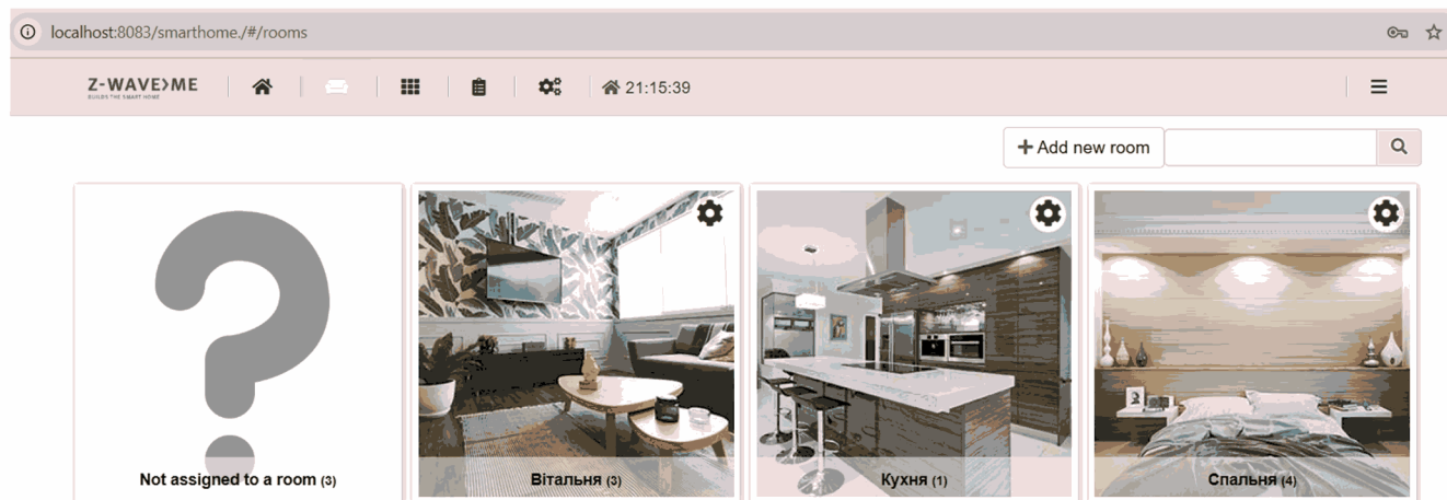
Рисунок 3.11 – Інтерфейс системи Z-Way з прикладом створених кімнат та розподілу пристроїв по зонах.
