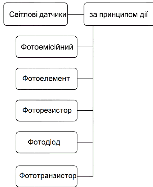
Рисунок 2.3 – Класифікація світлових датчиків за принципом дії
