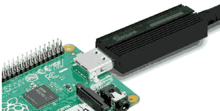
Рисунок 2.7 – Підключення ZigBee-адаптера до Raspberry Pi
