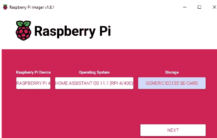
Рисунок 3.1 – Інтерфейс утиліти Raspberry Pi Imager (версія 1.8.1)
