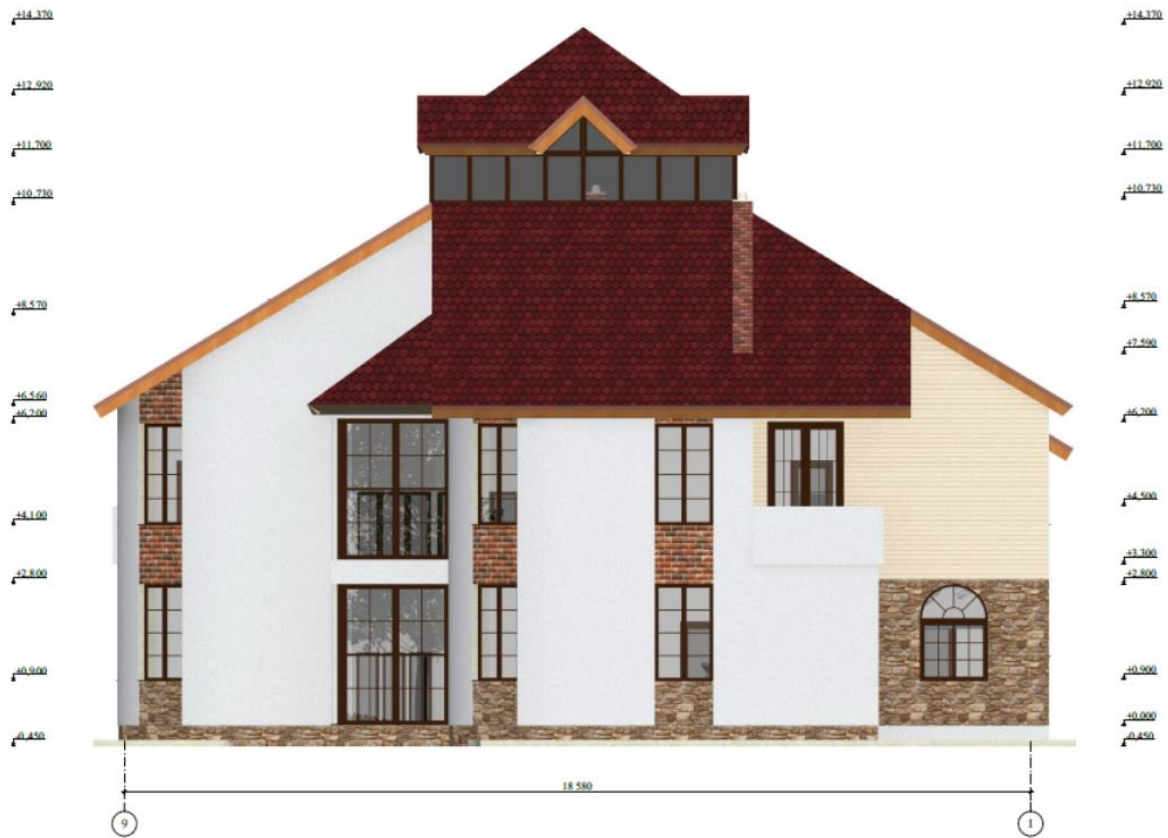
Рис.10 Індивідуальний житловий будинок з продовольчим магазином торговою площею 50 м 2 у м. Винники Львівського району Львівської області. Фасад в осях 9 – 1.
