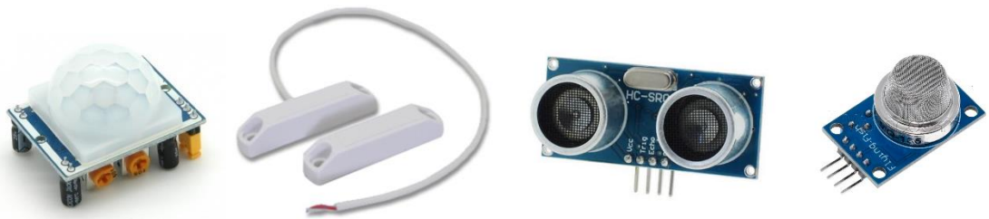
а) PIR-датчики руху б) датчик відкриття дверей в) ультразвукові датчики відстані г) димовий сенсор
