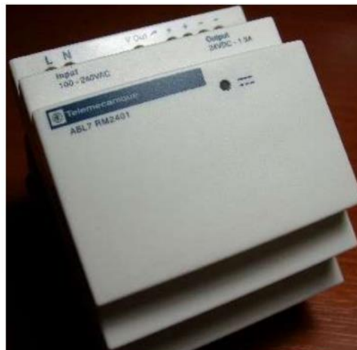
Рисунок 3.4 - Зовнішній вигляд блока живлення ABL7RM2401
