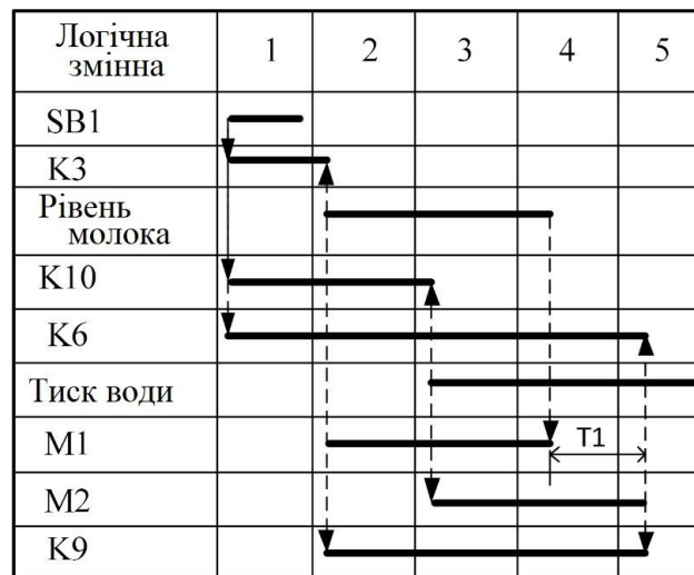
Рисунок 3.7 - Циклограма роботи пастеризаційної установки
