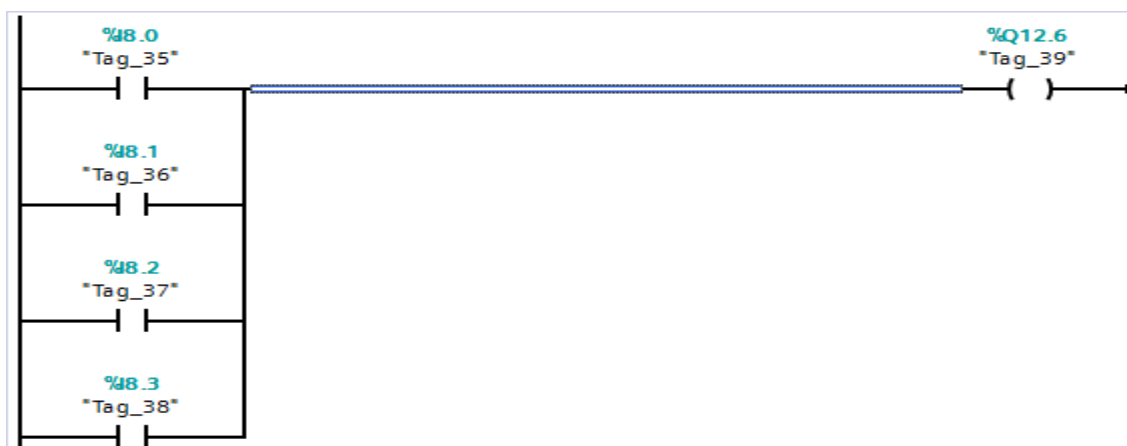
Рис. 2.31. Програма контуру захисту та блокування подачі палива
