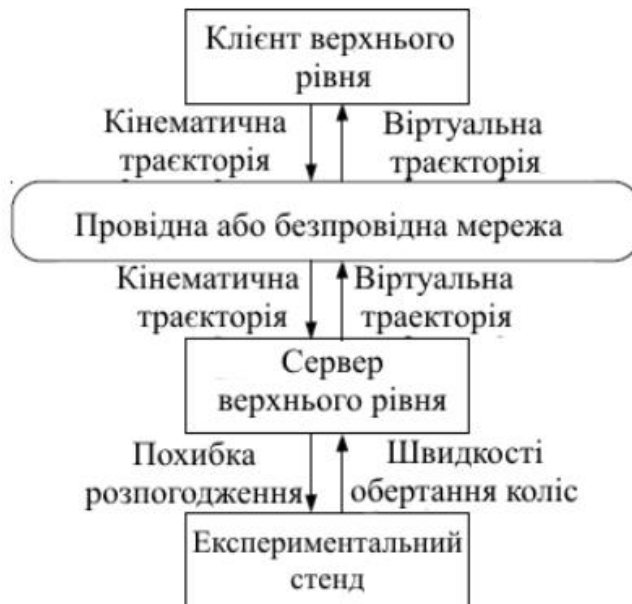
Рисунок 2.10 – Основні потоки даних між підсистемами гібридної моделі
