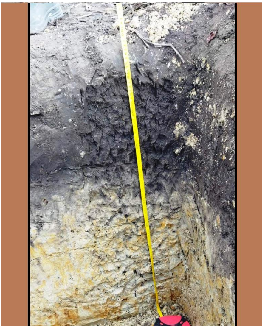
Рис. 2.2. Вигляд профілю і шурфа дернового глейового легкосуглинкового ґрунту на водно-льодовикових відкладах.
