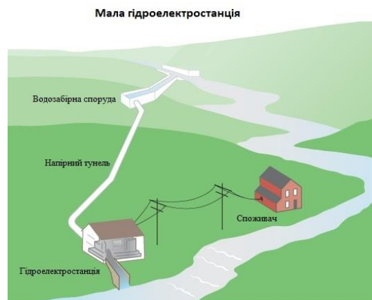
Рисунок 2.2 – Гідроелектростанція яка використовує принцип деривації води
