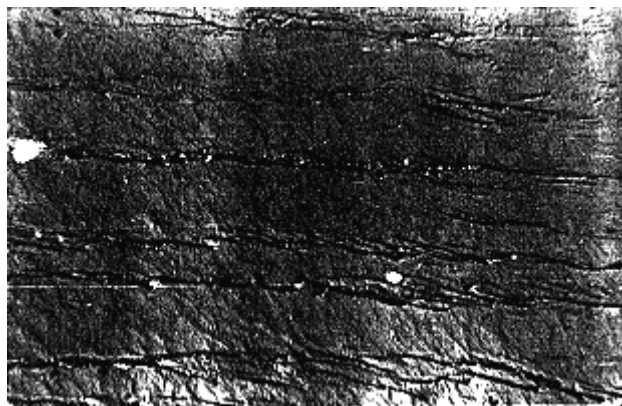
Рис. 3.9. Мікроструктура в смугах ковзання ( \varepsilon = 0,37\% ; N = 10000 циклів) \times 1200 .
