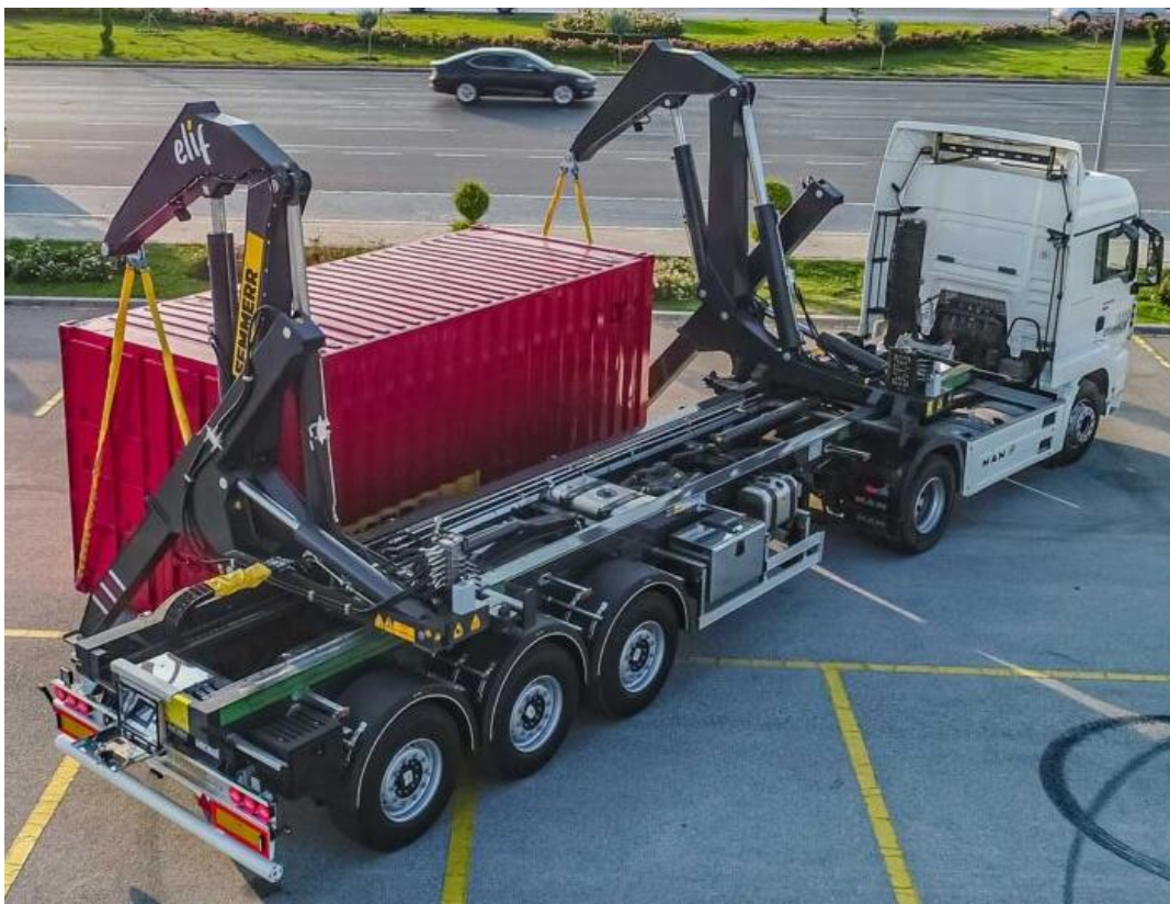
Рисунок 1.16 – Напівпричеп-контейнеровоз з бічним навантажувачем
