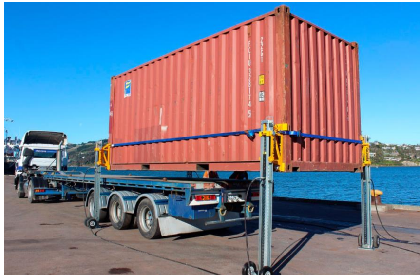
Рисунок 1.15 – Завантаження контейнера гідравлічним контейнерним домкратом
