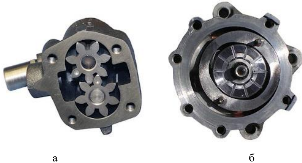
Рисунок 1.7 – Шестерневий (а) та лопатевий (б) гідронасоси.
