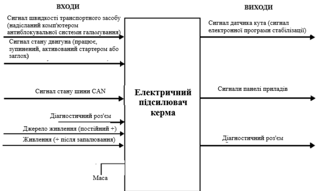
Рисунок 3.2 – Вхідні та вихідні сигнали і параметри електричного підсилювача керма
