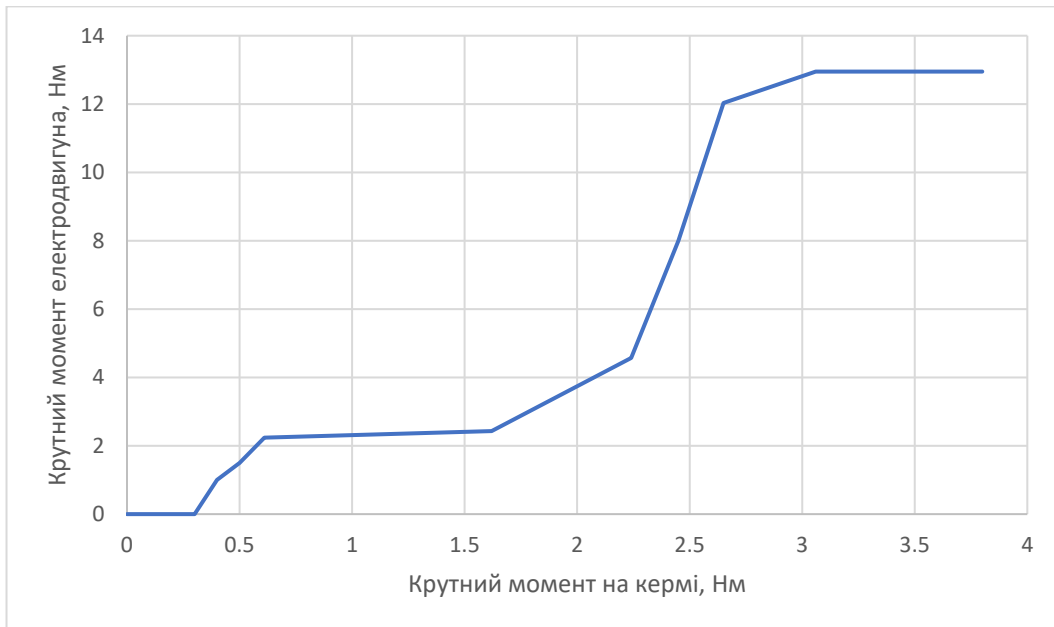
Рисунок 3.5 – Залежність зміни крутного моменту електродвигуна підсилювача рульового механізму відносно крутного моменту, що прикладено до керма.
