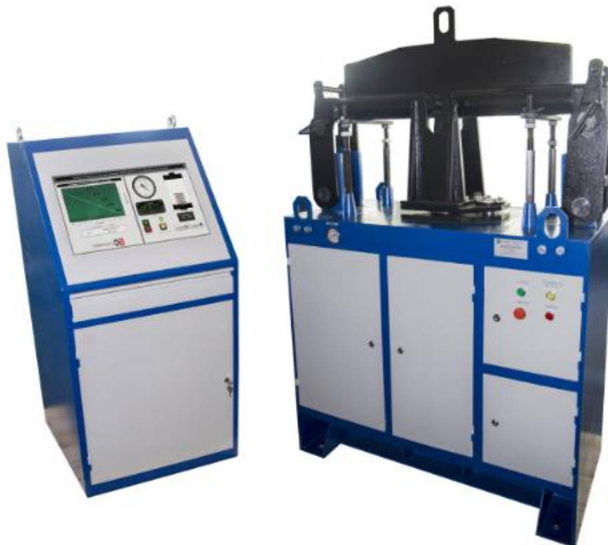
Рисунок 3.3 – Стенд для дослідження параметрів ресори.
