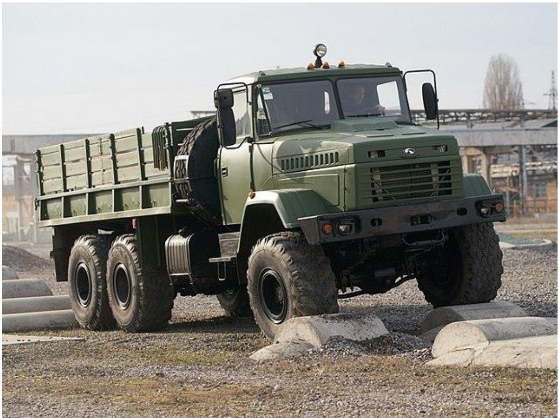
Рисунок 4.1 – КрАЗ-260 важкий вантажний автомобіль-всюдихід з колісною формулою бхб.
