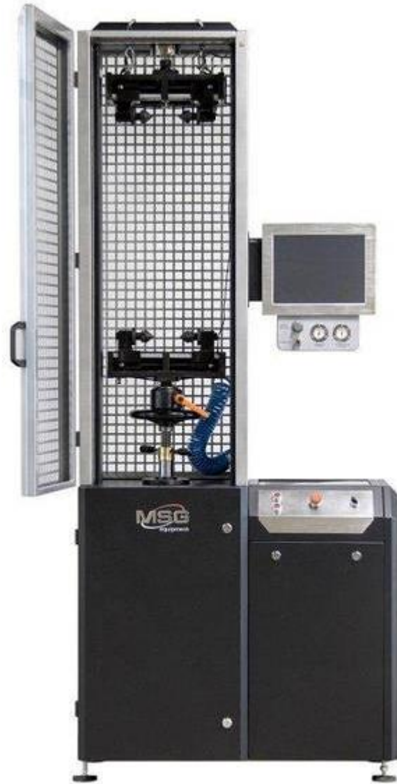
Рисунок 3.2 – Стенд для діагностики амортизаторів MSG MS1000
