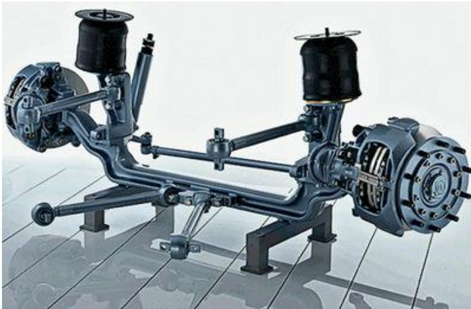
Рисунок 1.2 Пневматична підвіска автобуса
