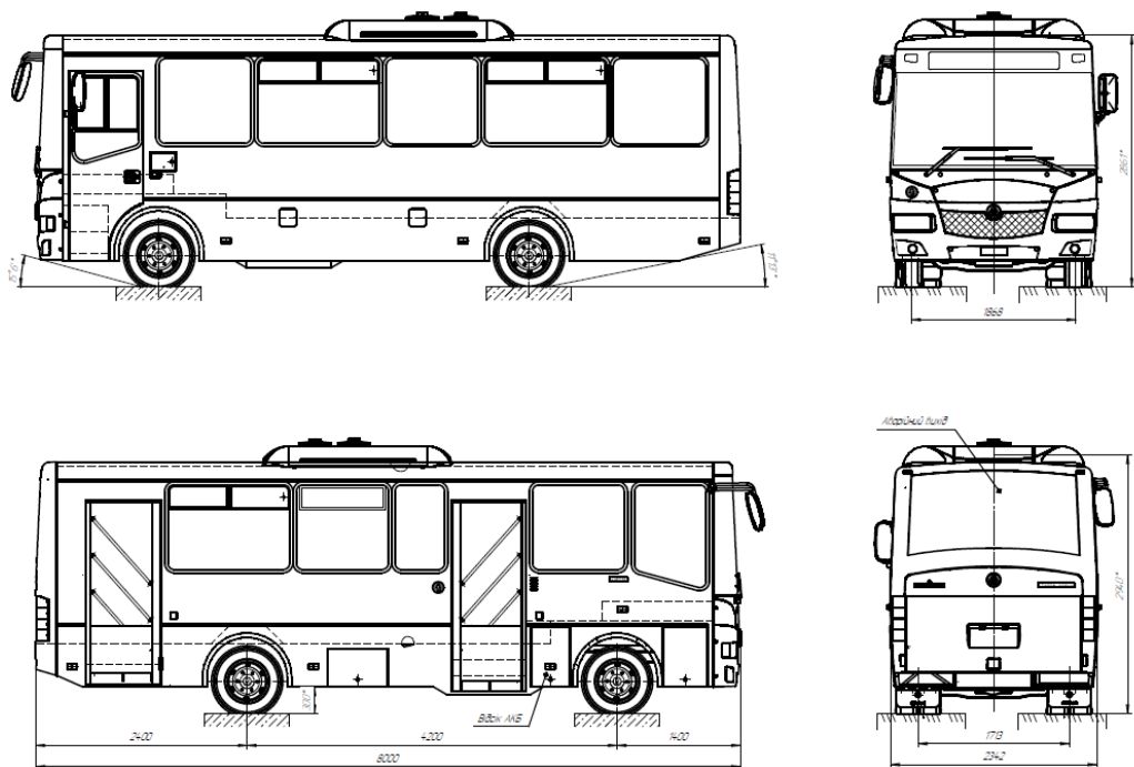
Рисунок 2.1 – Габаритне креслення автобуса.
