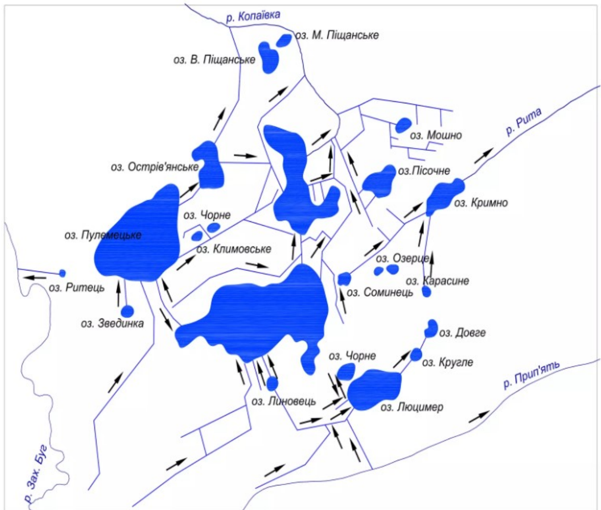
Рисунок 3.11 – Схема відведення поверхневих вод з території Шацького поозер'я
