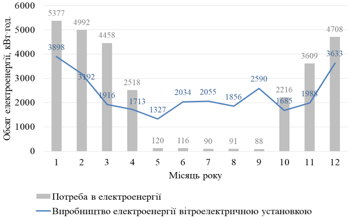
Рисунок 3.8 – Енергетичний баланс вітроелектричної системи для покриття потреб теплової помпи
