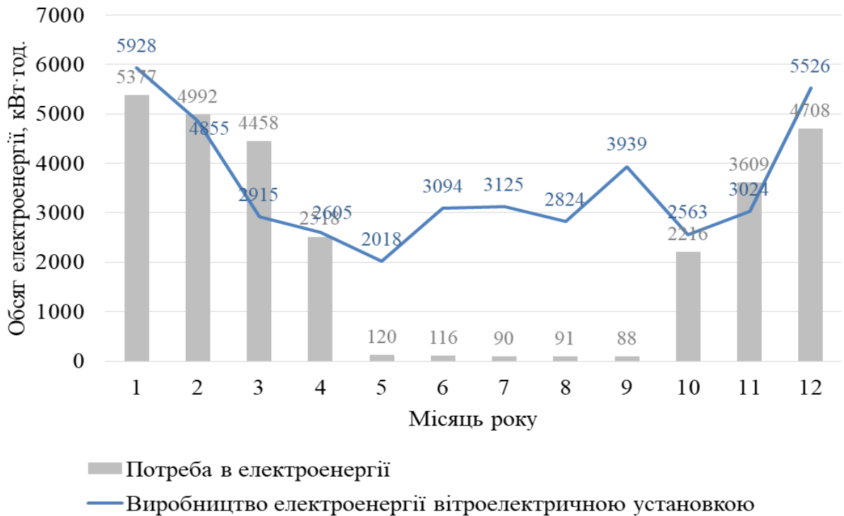
Рисунок 3.9 – Енергетичний баланс вітроелектричної системи для максимального покриття потреб теплової помпи
