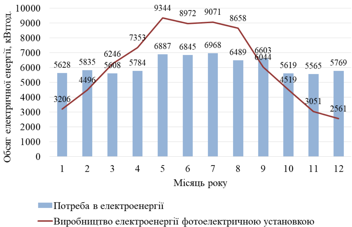
Рисунок 3.6 – Енергетичний баланс сонячної фотоелектричної системи
