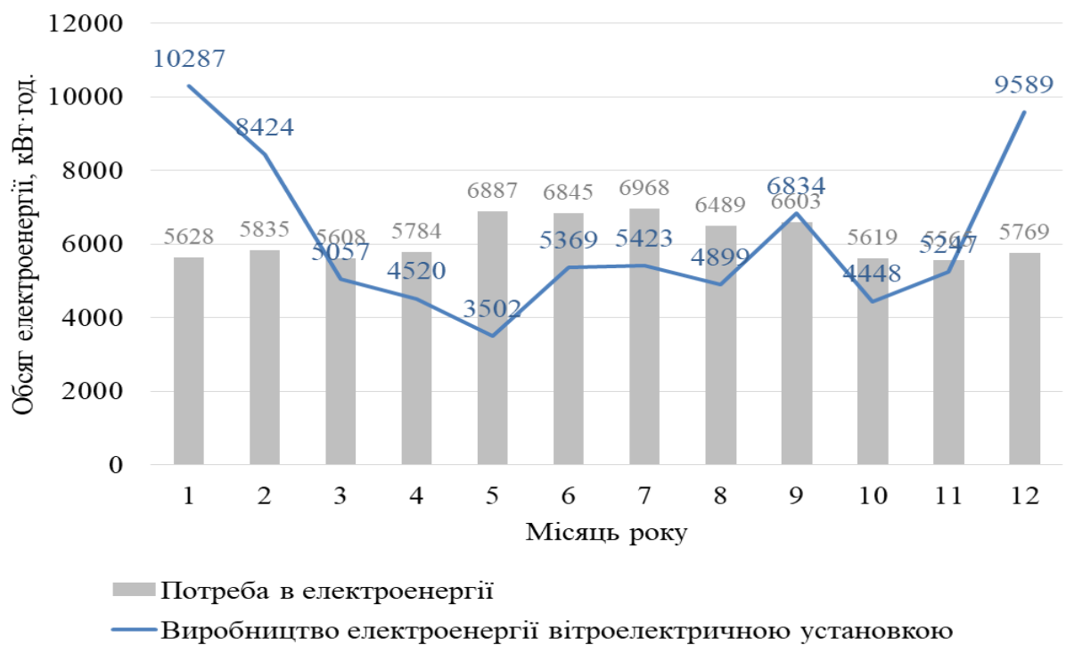
Рисунок 3.7 – Енергетичний баланс вітроелектричної системи для покриття потреб електрообладнання, систем освітлення та водопостачання
