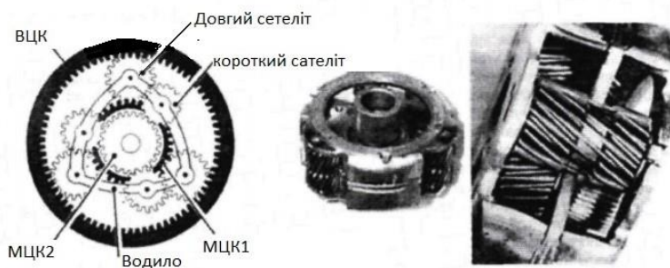
Рисунок 1.2 – Планетарна система Равіньйо (з зчепленими сателітами).
