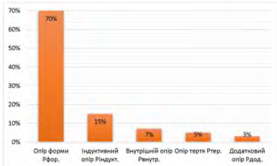
Рисунок 1.3 – Співставлення складових аеродинамічного опору легкового автомобіля
