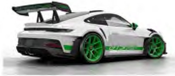
Рисунок 1.6 – Спойлер та антикрило на автомобілі Porsche 911 GT3 RS
