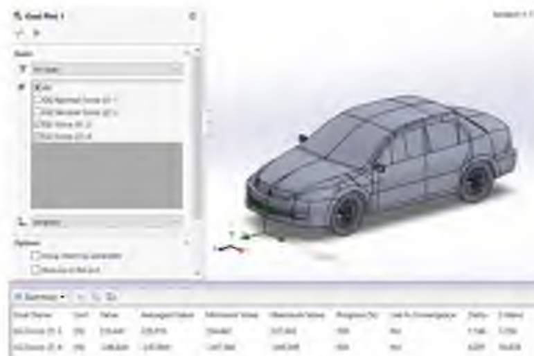
Рисунок 5.4 – Визначення сили лобового опору та притискної сили, що діють на автомобіль Mitsubishi Lancer
