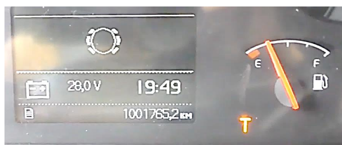
Рисунок 2.9 Інформації про критичний знос гальмівних колодок
