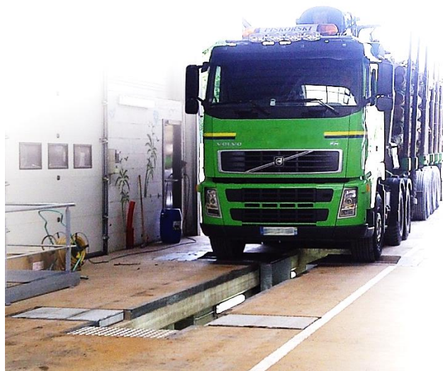
Рисунок 2.28 Універсальний гальмівний роликовий стенд Ravaglioli RT615V / RT622V / RT630V встановлений на оглядовій канаві
