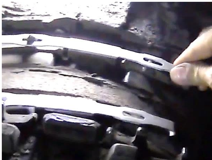
Рисунок 2.14 Фіксування колодок пластинчастими пружинами
