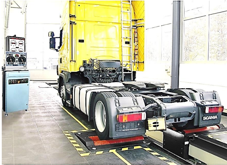
Рисунок 2.21 Роликовий гальмівний стенд 13,0 т / вісь MBT 4250 EUROSYSTEM (IW4 EUROSYSTEM), МАНА (Німеччина)
