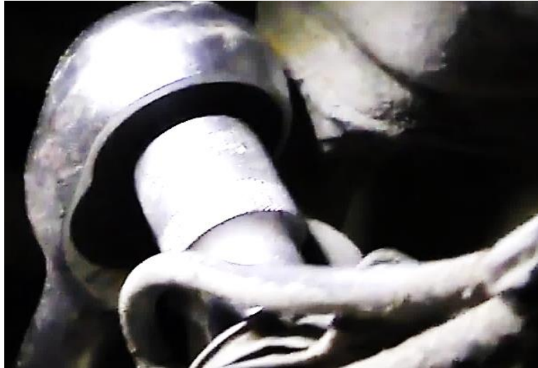
Рисунок 2.16 Підведення поршня до колодок для створення мінімального зазору
