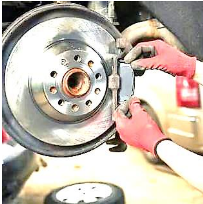
Рисунок 2.8 Фрагмент операції виймання гальмівної колодки з супорта гальма вантажного автомобіля
