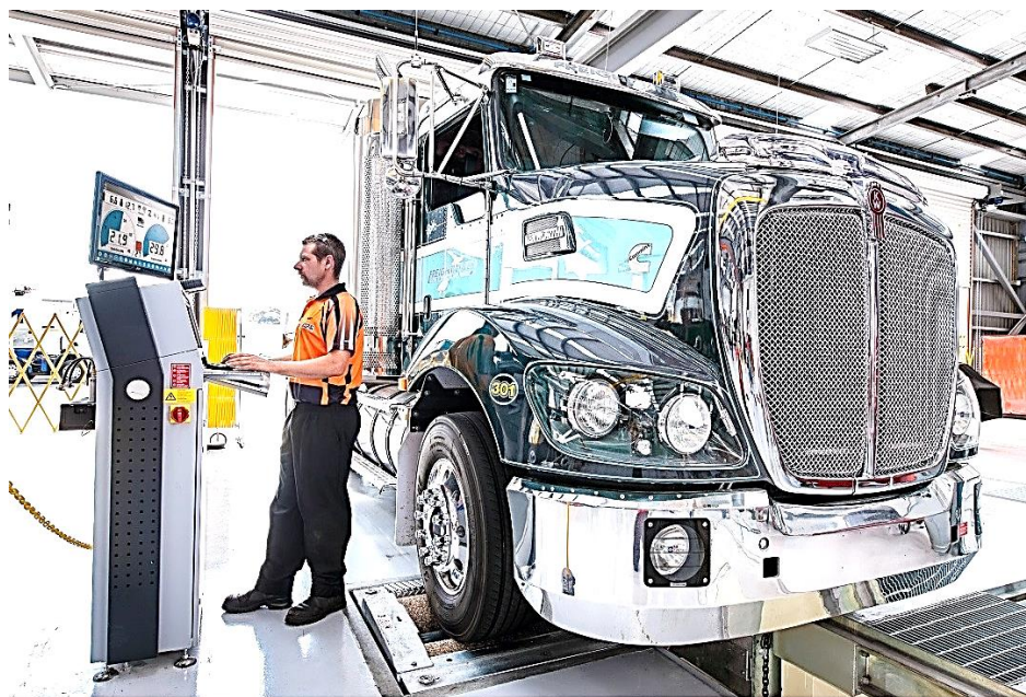
Рисунок 2.22 Робоче місце німецького роликового гальмівного стенда МАНА з зусиллям 18000 кг на вісь MBT 7250
