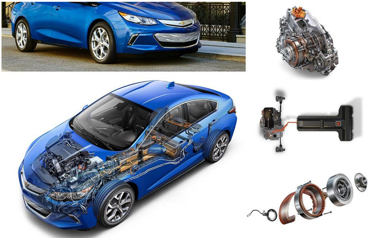
Рисунок 2.3 - Передача енергії в послідовних гібридних автомобілях типу (REEV)
