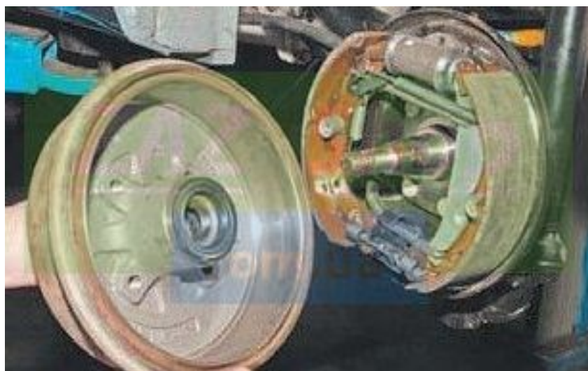
Рисунок 3.2. Знятий гальмівний барабан.
