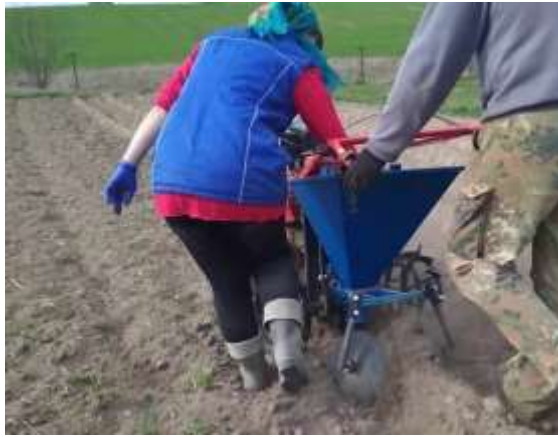
Рис. 1.6 – Картопляна саджалка, яка працює із застосуванням ручної роботи
