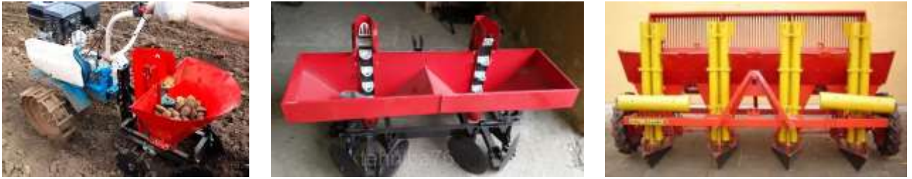
Рис. 1.10 – Одно-, дво-, та чотирирядкові саджалки картоплі (зліва направо)
