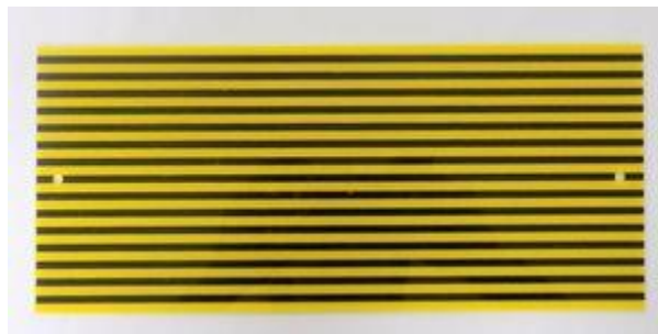
Рисунок 2.2 – Коригуюча панель для усунення вм'ятин
