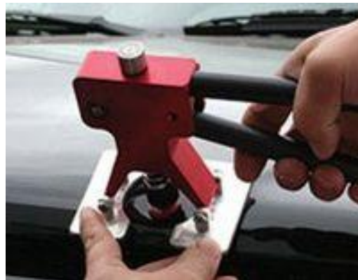
Рисунок 2.3 – Усунення вм'ятин клейовим методом
