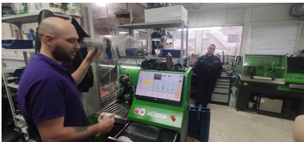
Рисунок 1.4 – Стенд для діагностики і очищення та калібрування форсунок, перевірку параметрів рейок
