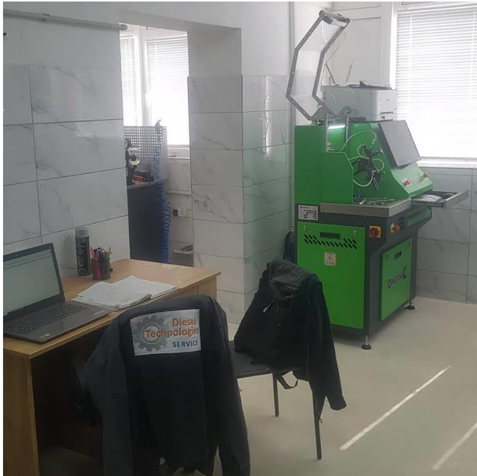
Рисунок 1.8 – Стенди для перевірки паливної апаратури
