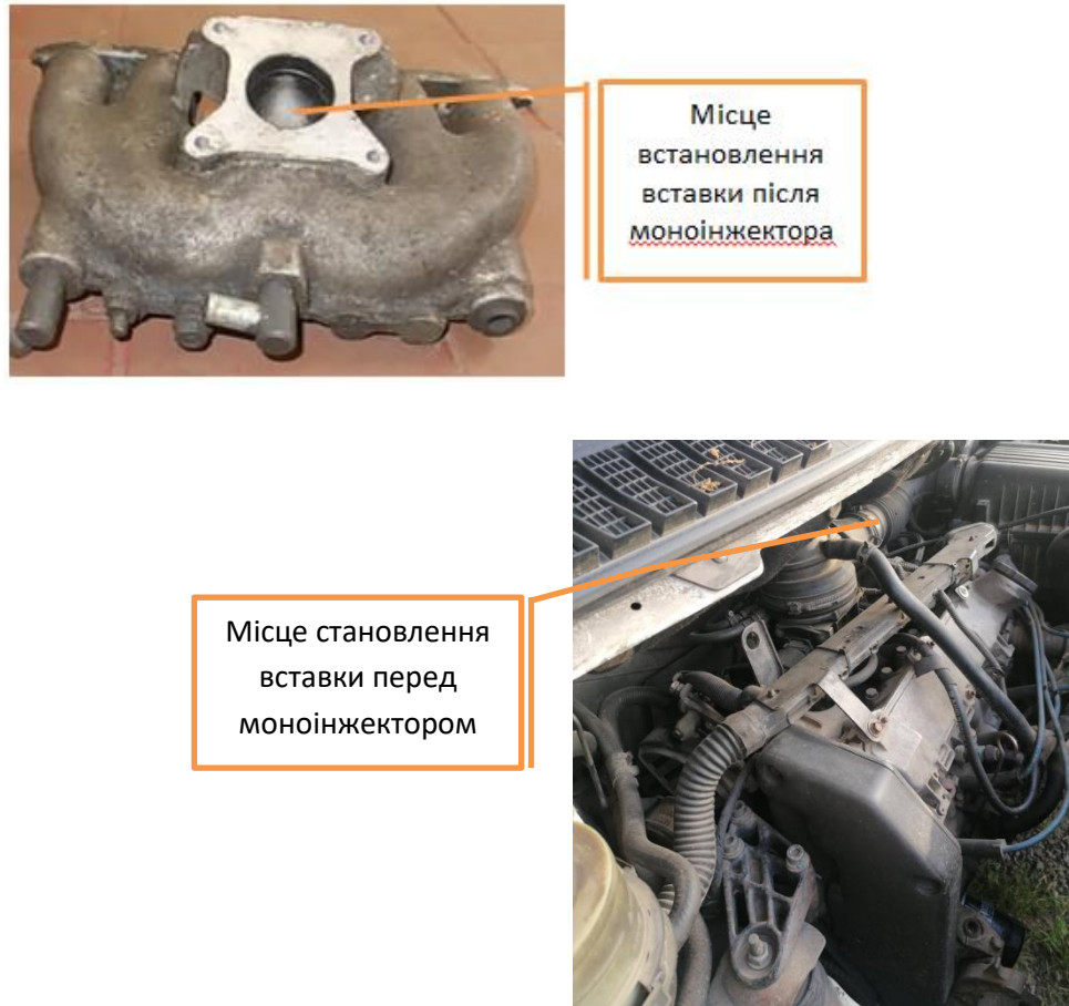
Рисунок 3.3 – Місце розміщення вставки у впускній магістралі моноінжекторного двигуна
