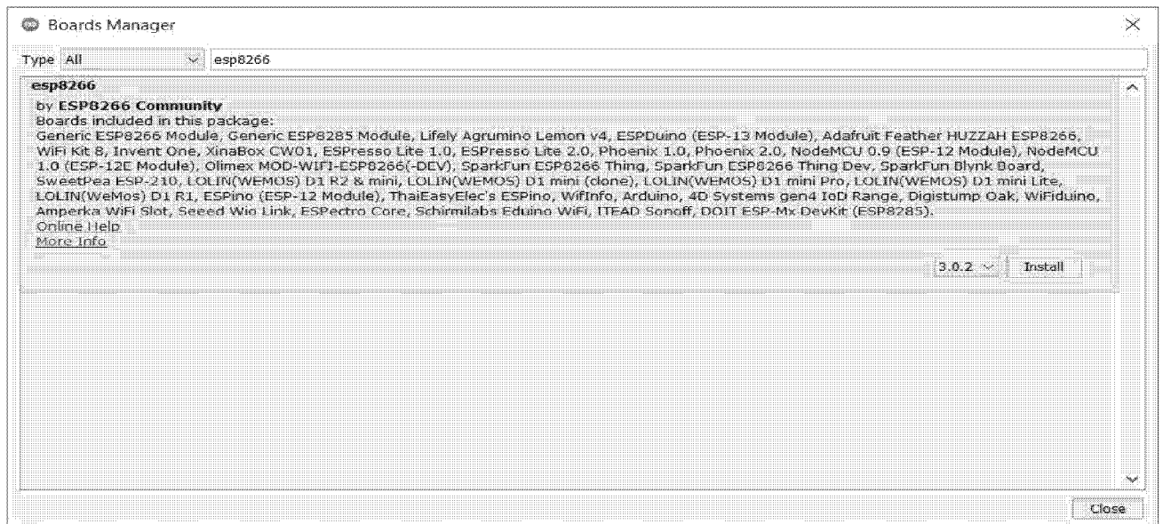
Рисунок 3.6 – Процес встановлення плагіна для роботи з платформою ESP8266 у вікні «Boards Manager»
