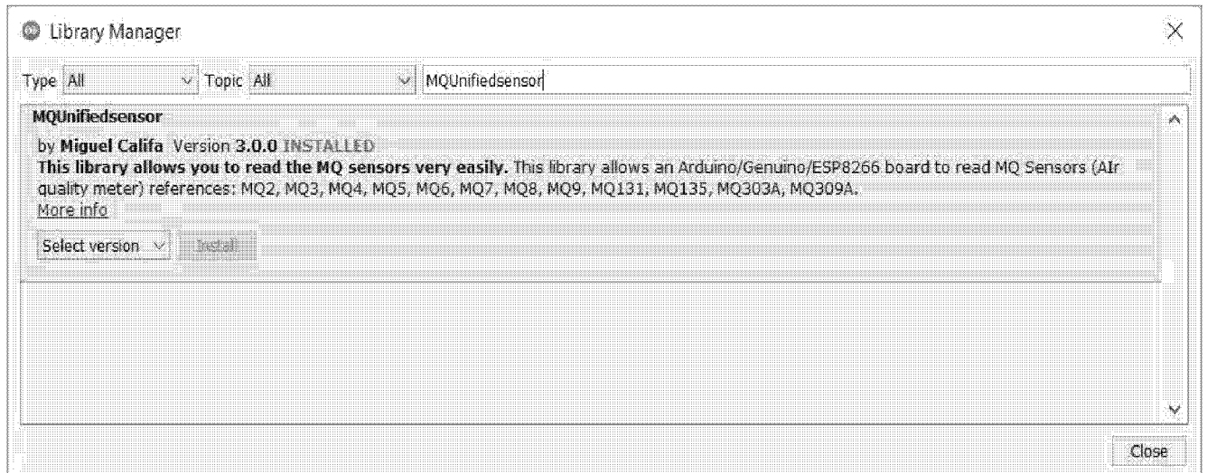
Рисунок 3.8 – Встановлення бібліотеки MQUnifiedsensor в Arduino IDE для роботи з сенсором MQ135 для вимірювання концентрації CO 2
