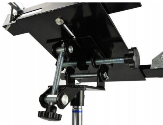
Рисунок 3.2 Керована опора стенда Hercules
