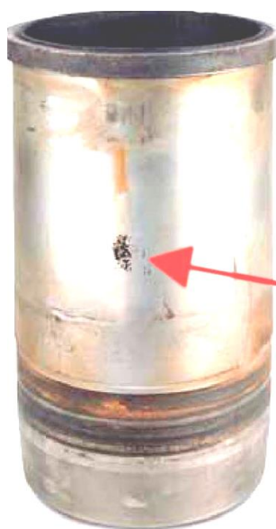
Рисунок 2.3. Пошкодження гільзи ззовні внаслідок порушення температурного режиму дії охолоджуючої рідини
