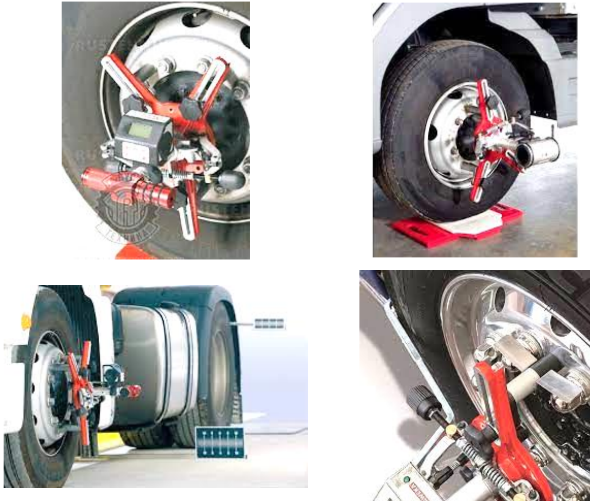
Рисунок 2.6 Варіанти застосування елементів стенда під час виконання контрольних операцій
