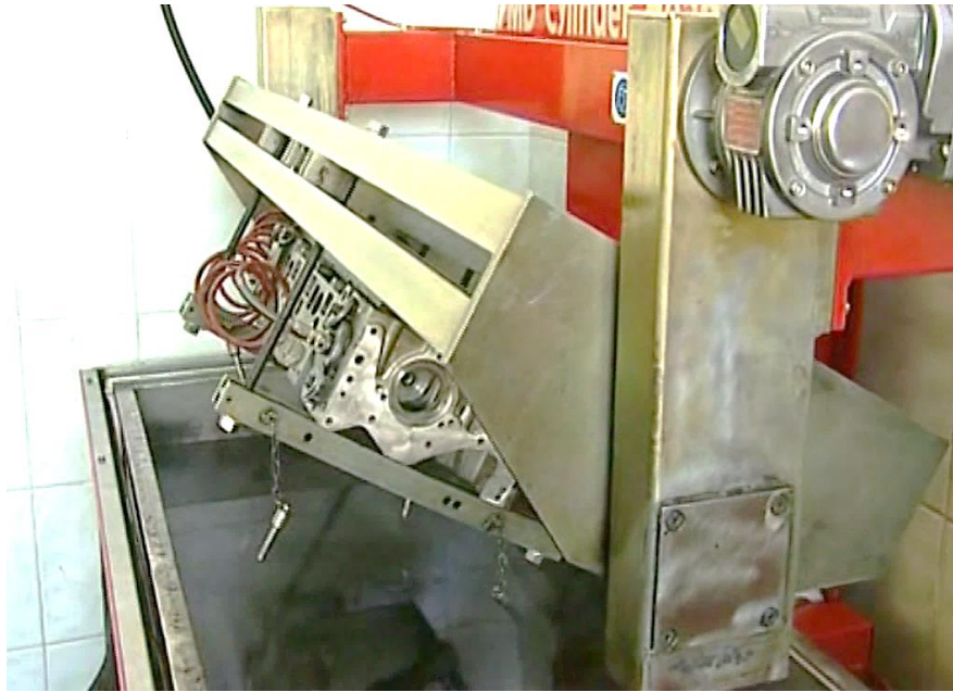
Рисунок 2.2 Перевірка головки блоку на герметичність
