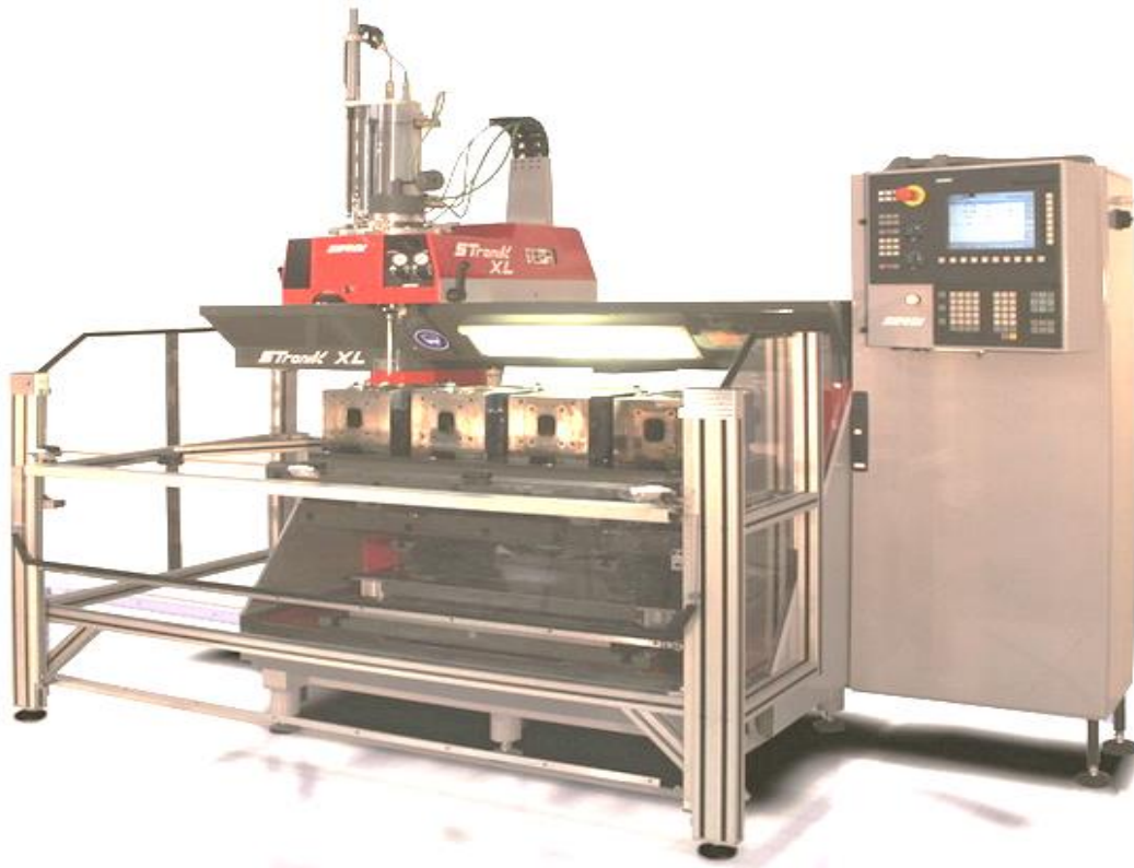
Рисунок 2.6 Верстат для ремонту головок циліндрів SERDI STRONIK XL
