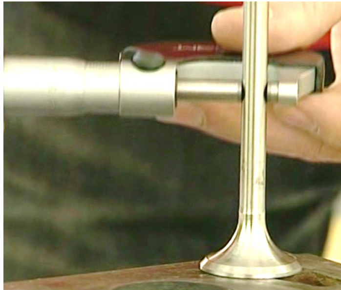
Рисунок 2.7 Визначення діаметра стержня клапана
