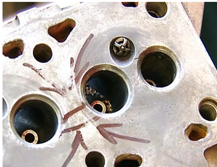
Рисунок 2.10 нова напрямна втулка клапана запресована в отвір головки циліндрів
