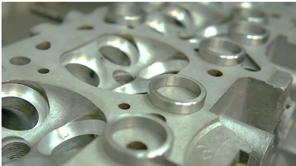
Рисунок 2.12 Комплект кілець підібраних до розмірі посадочних місць в головці циліндрів
