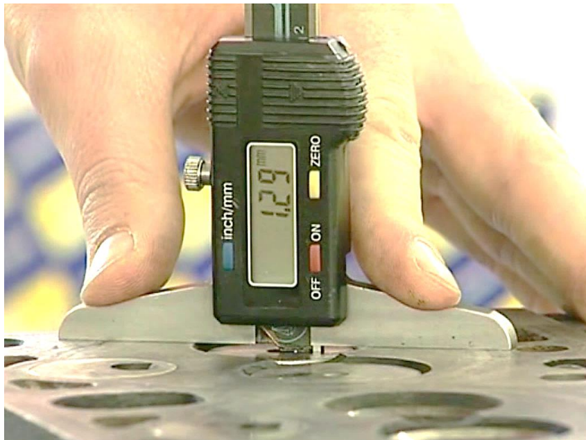
Рисунок 2.1 Перевірка глибини залягання клапана
