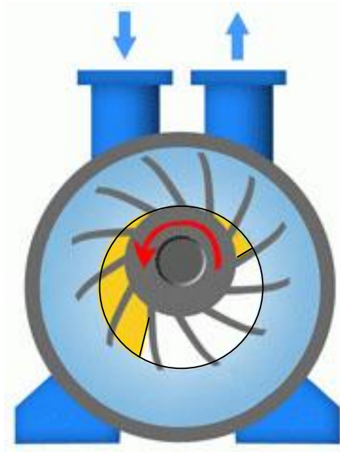
Рисунок 1.7 – Схема водокільцевої вакуумної помпи
