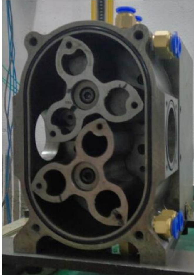
Рисунок 2.5 – Двороторна трилопатева вакуумна помпа зі знятою боковою кришкою
