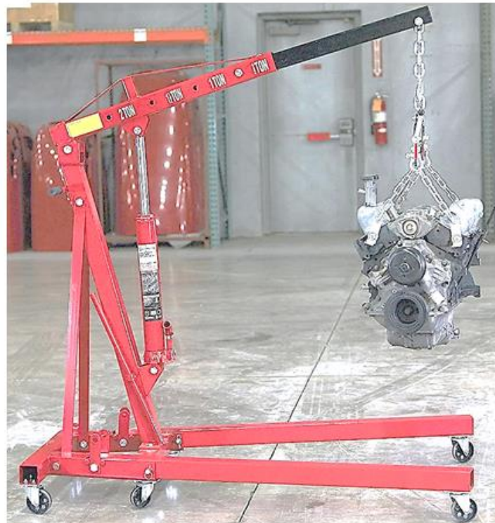
Рисунок 1. 5 – Гідравлічний кран для демонтажу і монтажу агрегатів моделі TORIN T32002X
