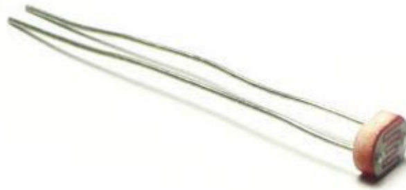
Рис. 3.5 – LDR давач інтенсивності світла
