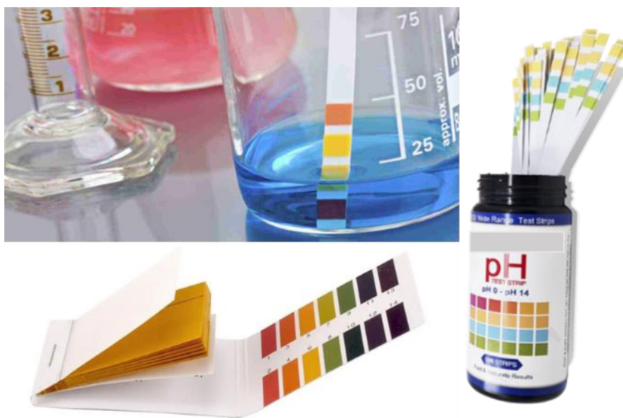
Рисунок 1. Визначення кислотності води за допомогою індикаторних папірців (смужок)
