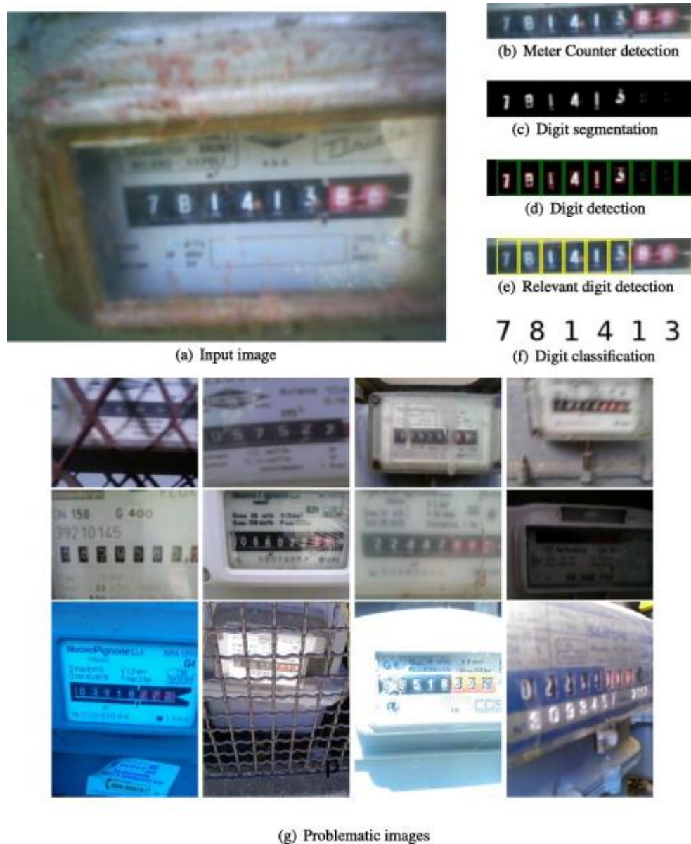
Рисунок 1.10 – Приклад оптичного розпізнавання символів за допомогою запропонованого алгоритму [36]: а) Вхідне зображення; б) виявлена область інтересу, отримана запропонованим алгоритмом; с) цифри відокремлені від фону; d) усі цифри та їх обмежувальну рамку виявлено; е) частина цифр виявляється; f) частина цифр класифікується; г) кілька прикладів проблемних зображень з усього набору даних
