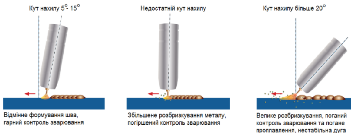
Рисунок 3.20 – Вплив нахилу пальника на якість зварювання
