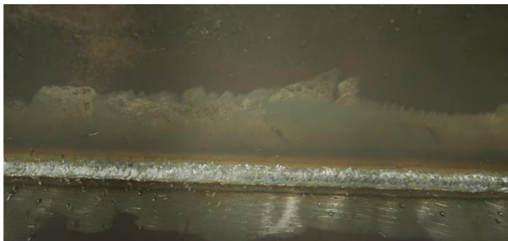
Рисунок 3.27 – Зразок зварного шва, виконаного в режимі перехідної дуги
