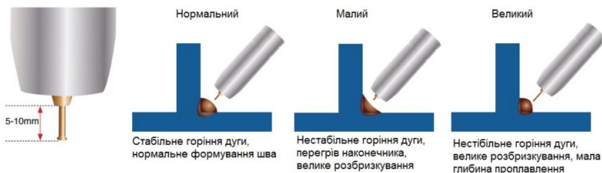
Рисунок 3.17 – Вплив вильоту електродного дроту на формування зварного шва
