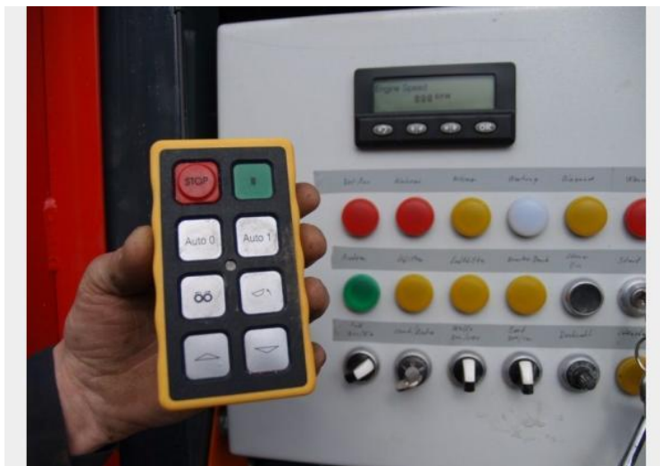
Рисунок 1.13 - Дистанційне управління устаткуванням машини VZ - 750, для безпечного керування.
