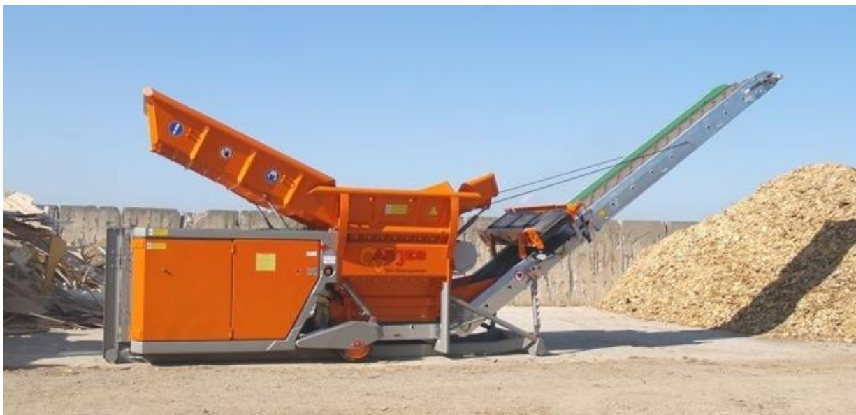
Рисунок 1.8 - Машина для первинного подріблення деревини VZ -750
