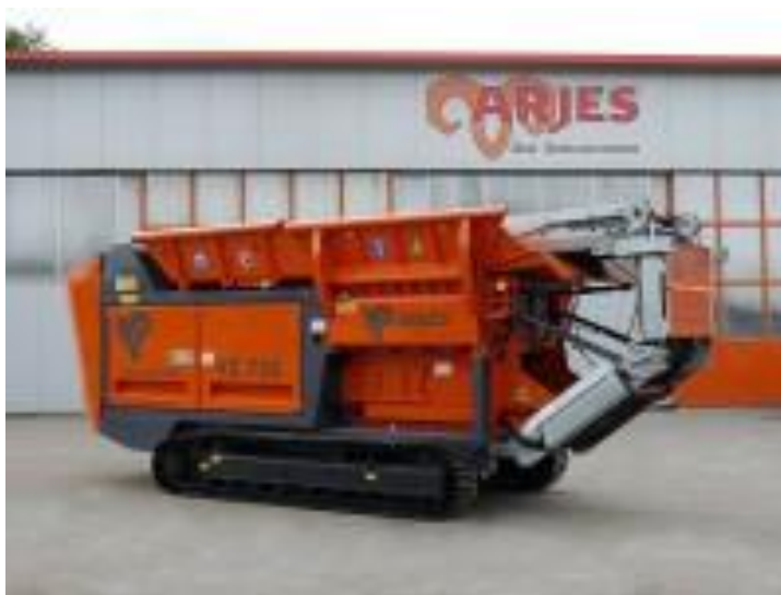
Рисунок 1.14 - Гусеничне шасі машини для подріблення сировини VZ -750
