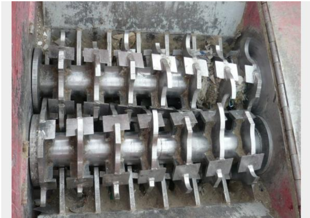
Рисунок 1.11 - Вали подібнювача VZ -750
