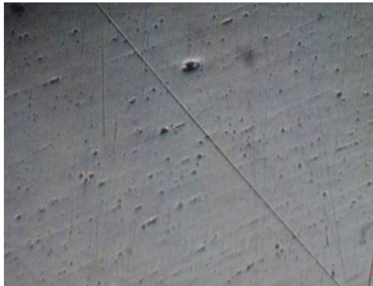
Рисунок 3.2 – Неметалеві включення в досліджуємому металі, ×750.
