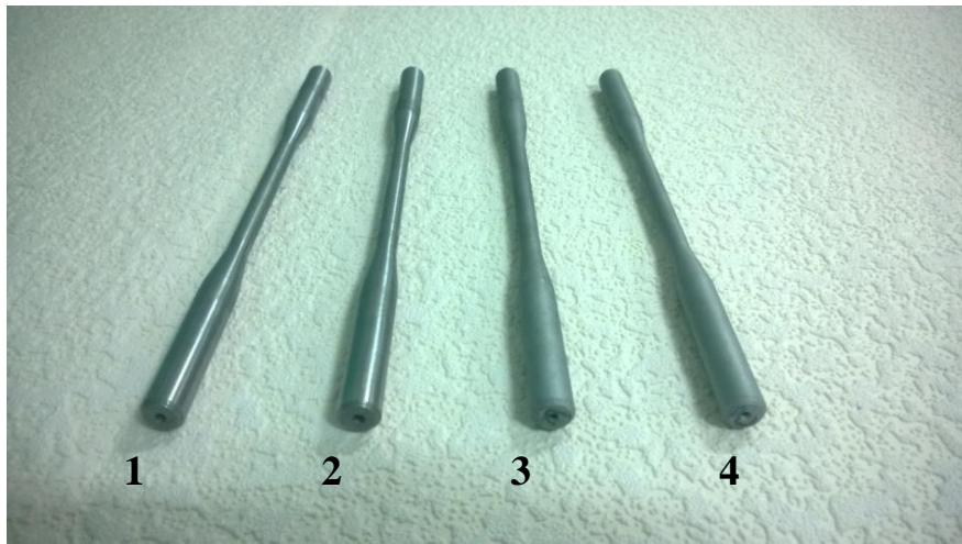
Рисунок 2.2 – Зразки для випробувань на втомну витривалість: 1, 2 – без обробки, 3, 4 – дробоструминне оброблення
