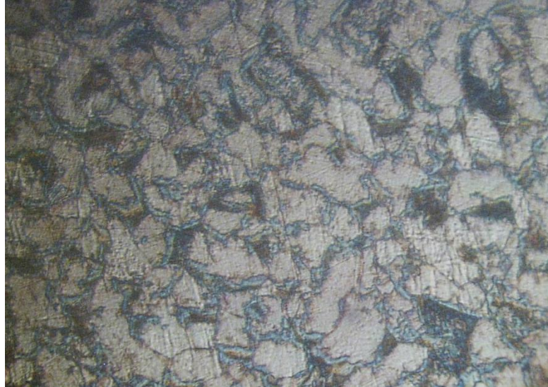
Рисунок 3.1 – Структура безвуглецевого слою пружинних стійок, ×500
