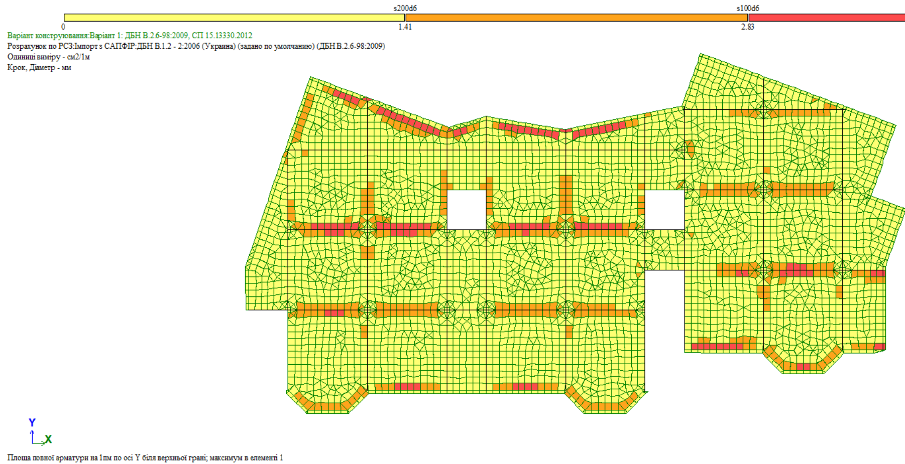
Рис. 2.6 Варіанти конструювання діаметру арматури
