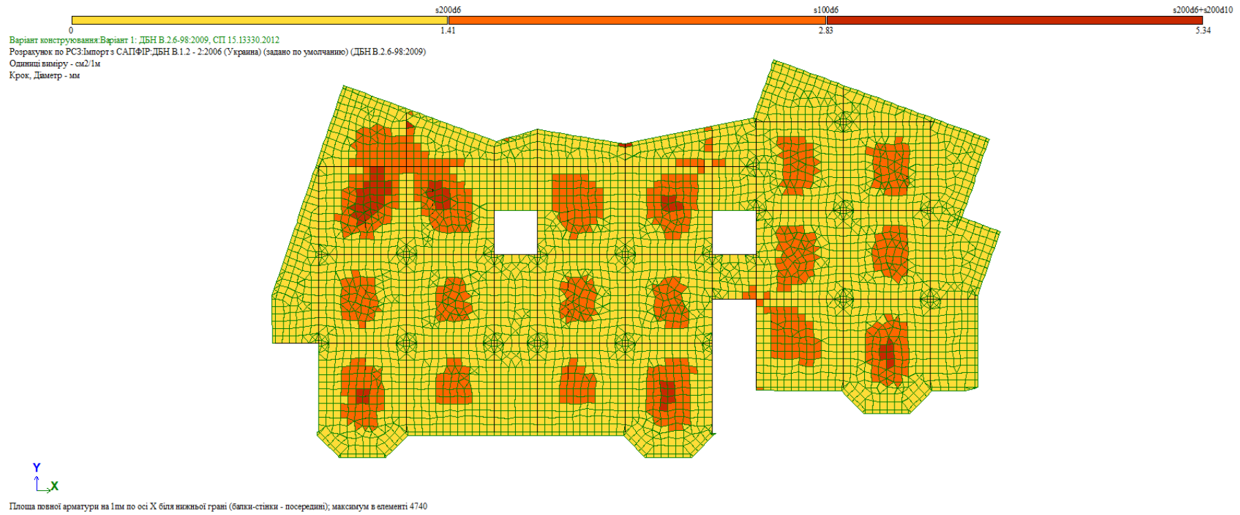
Рис. 2.5 Варіанти конструювання кроку арматури
