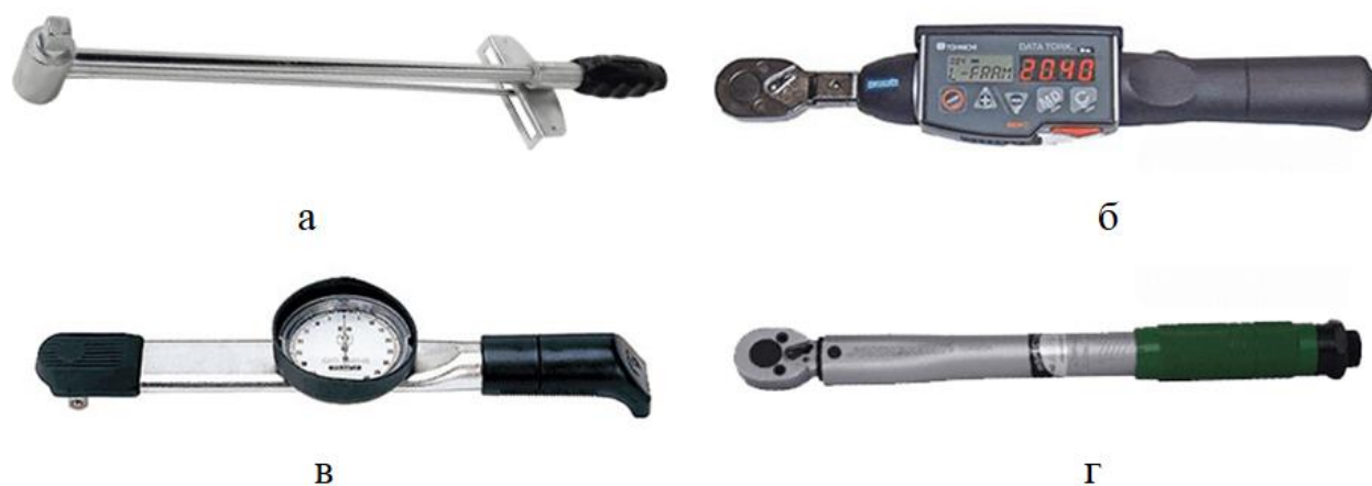
Рисунок 1.17 – Динамометричні ключі: а - шкальний, б – електронний, в – індикаторний, г - граничний
