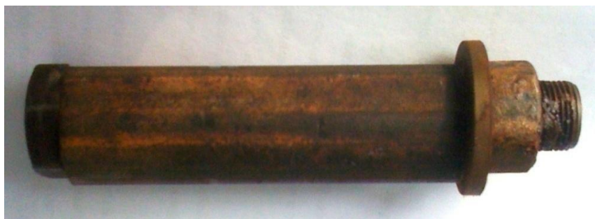
Рисунок 3.11 – Різьбова пара в процесі корудування
