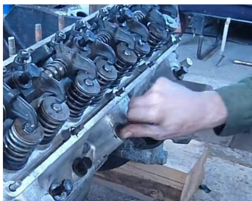
Рисунок 3.15 – Нанесення на болти моторної оливи та їх встановлення
