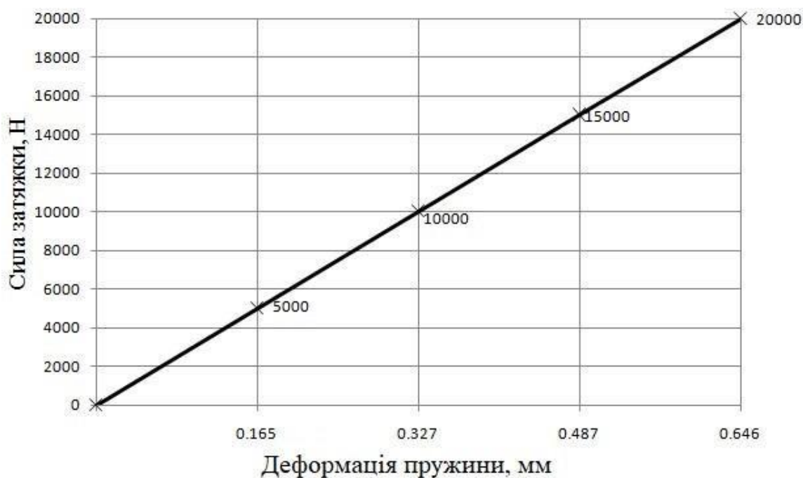
Рисунок 3.10 – Тарувальна характеристика динамометричної пружини
