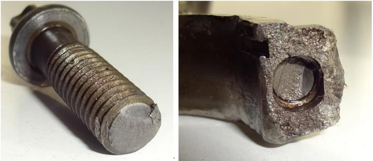
Рисунок 3.1 – Руйнування шатунного болта внаслідок виникнення мікротріщини, яка в свою чергу виникла із-за перетягування з'єднання
