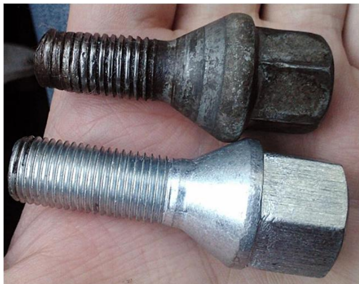
Рисунок 3.3 – Знос різьби болта кріплення колеса внаслідок недотягування
