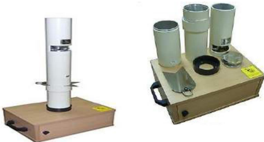
Рисунок 3.4 – Дослідження натури літровою пуркою ПХ-2
