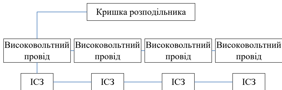
Рисунок 3.3 – Структурна схема моделі надійності СЗ для відмови типу "збільшення витрати палива, зниження потужності"
