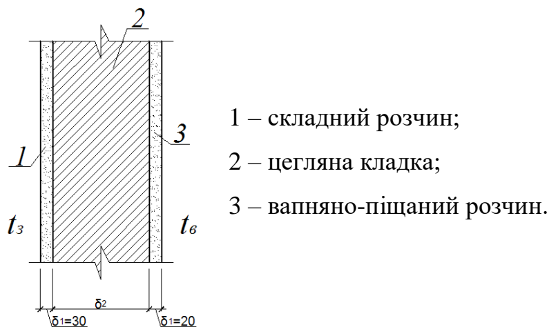
Рис.1.1. Конструкція зовнішньої цегляної стіни
