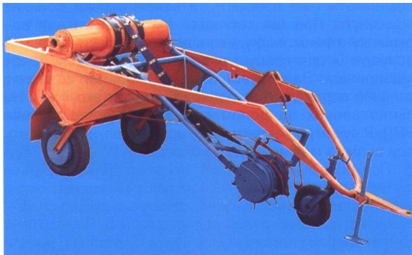
Рисунок 1.7 – Обертач стрічок льону ОЛП-1
