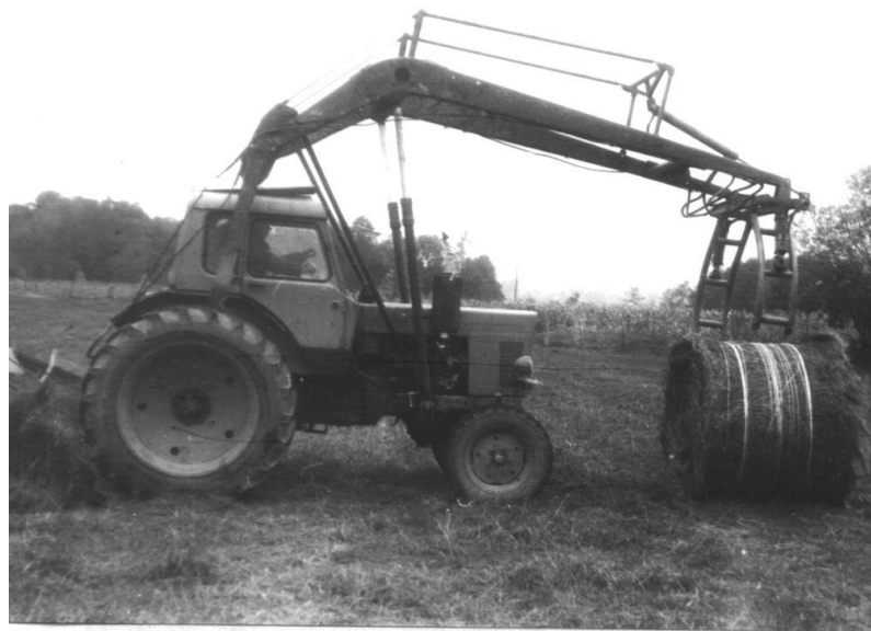
Рисунок 1.9 – Фронтальний навантажувач ПФ-0,5 з пристроєм ПРЛ-0,5 для вантаження рулонів
