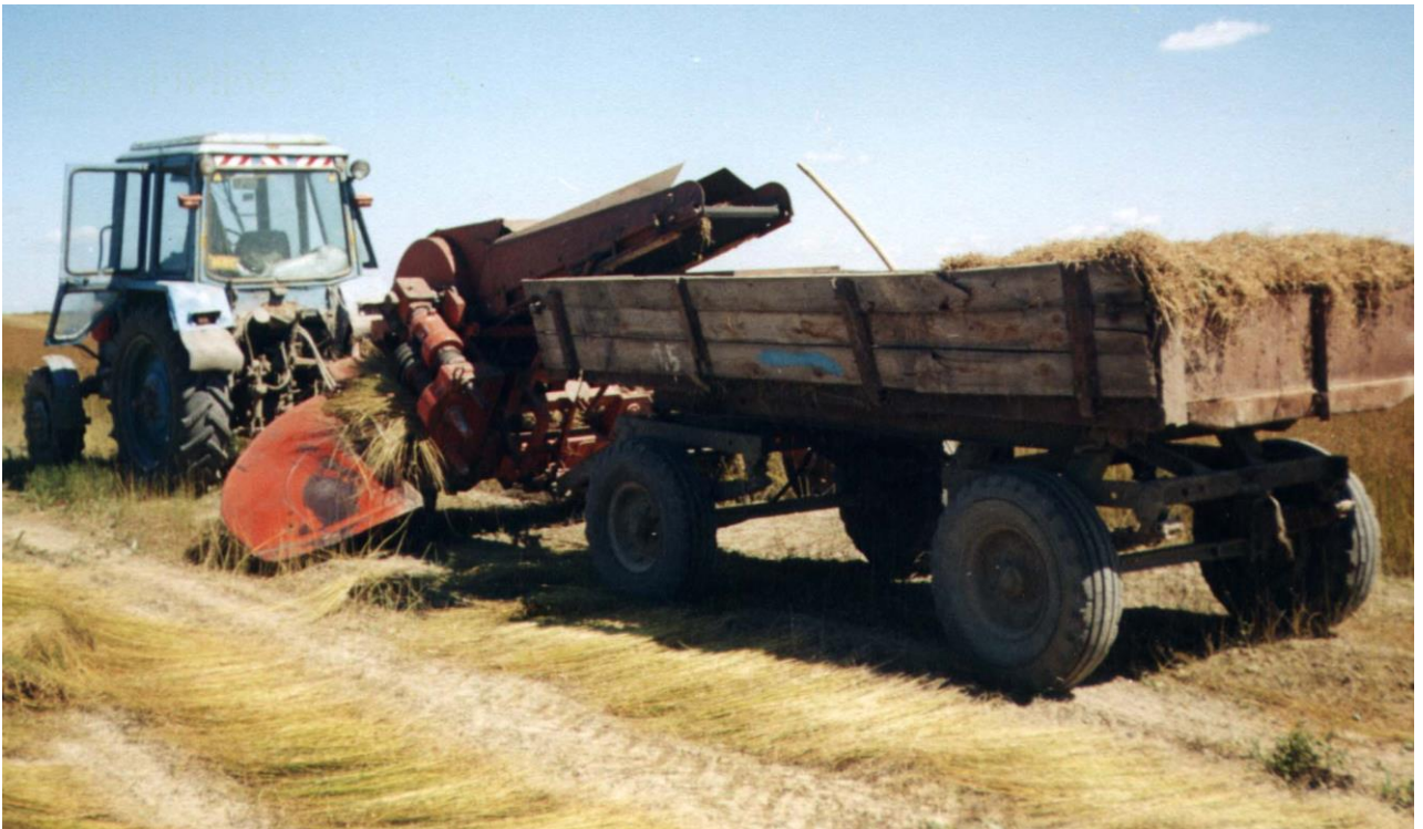
Рисунок 1.5 – Льонозбиральний комбайн ЛК-4А
